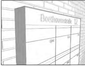
Anlage wieder auf die Montageschiene einhängen. Vor dem loslassen prüfen, ob die Anlage sicher eingehangen ist.
