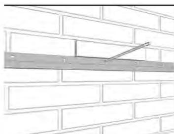
mitgelieferte Montageschiene mit Hilfe einer Wasserwaage grade ausrichten und Befestigungspunkte markieren.
